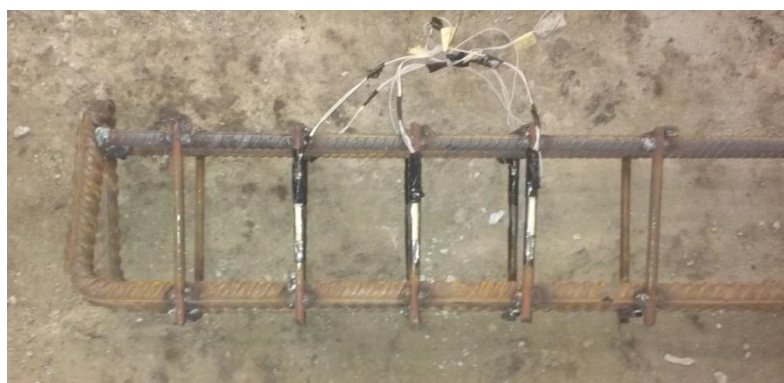
Рис. 2.14. Розміщення тензорезисторів на поперечні арматурі
