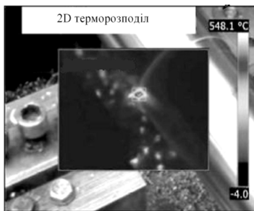
Рис. 2.5. 2D зображення розподілу температури в зоні різання отримане тепловізором.
