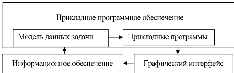
Рис.1. Архитектура программного обеспечения.
