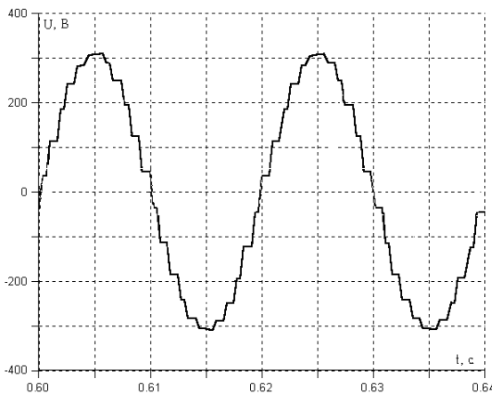
Рис.9. Фазна напруга на виході каскадного інвертора (4 АІН).
