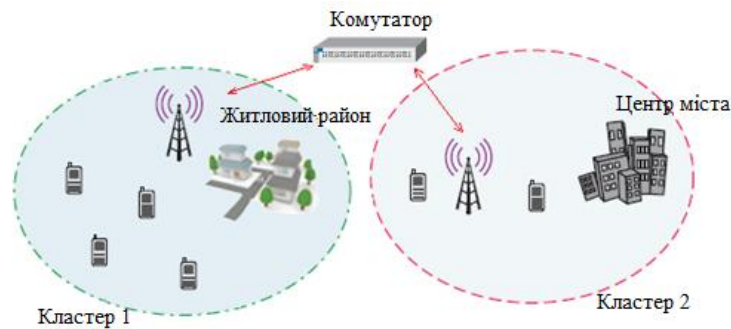
Рис. 4. Структурна схема мережі для двох кластерів ВБС
