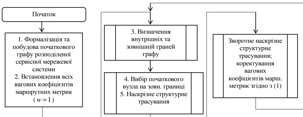
Рис. 1. Алгоритм коректування вагових коефіцієнтів маршрутних метрик для балансування сервісного навантаження за допомогою наскрізного структурного трасування у хмарній мережевій платформі
