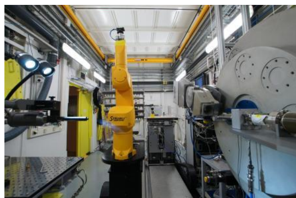
Рис. 2.3. Порошковий дифрактометр на променевій лінії ID22 (праворуч), та робот для зміни зразка (в центрі).
