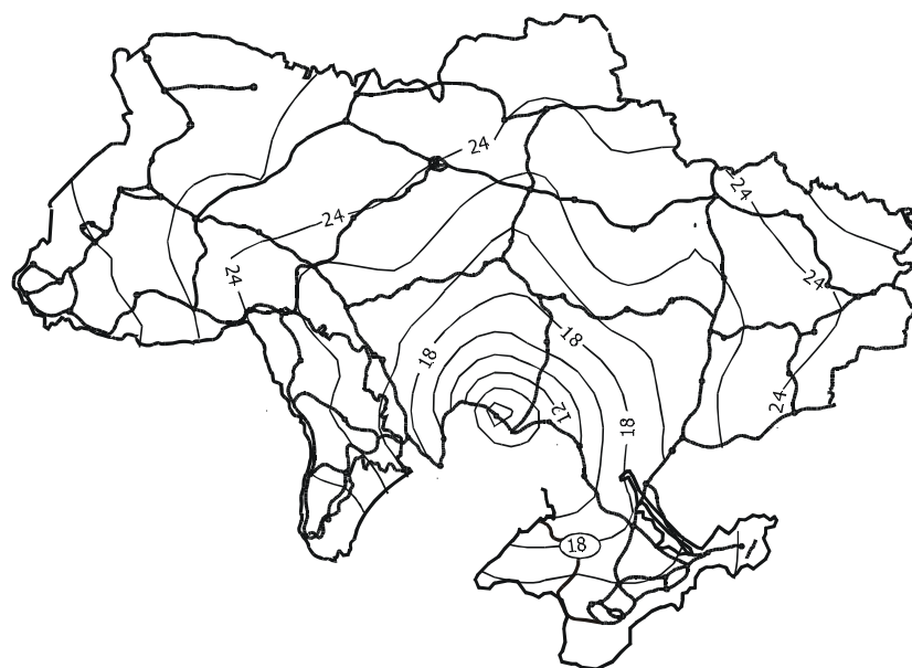
Рис. 6. Ізолінії похибок визначення висот пунктів нівелірної мережі першого класу, зумовлених сумарним впливом випадкових і систематичних похибок та деформацій земної поверхні (вихідний пункт – фундаментальний репер м. Миколаєва)
