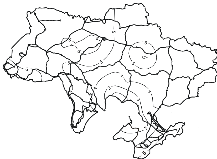
Рис. 5. Ізолінії похибок визначення висот пунктів нівелірної мережі першого класу, зумовлених деформаціями земної поверхні (вихідний пункт – фундаментальний репер м.Миколаєва)
