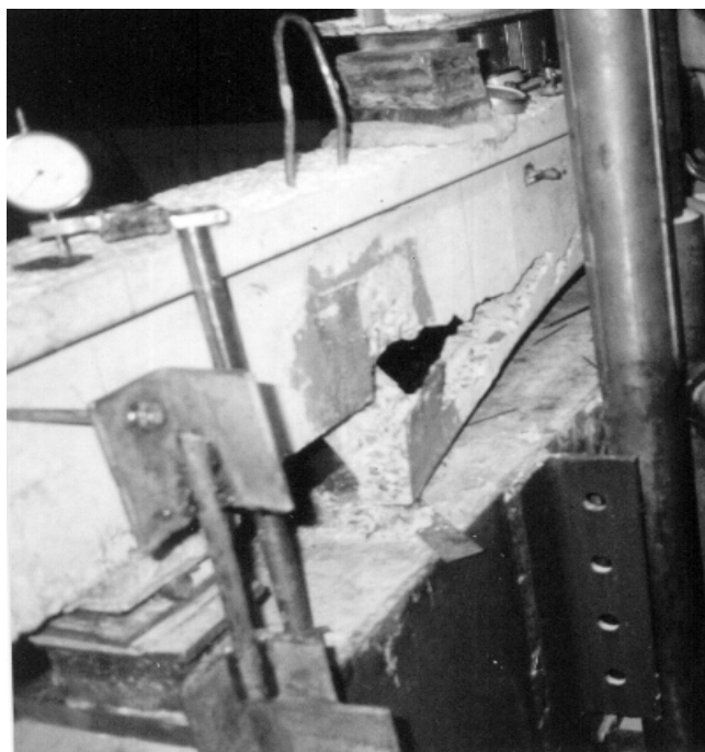
Рис. 5. Характер відривання бетону ребра балки II-БПС-2 в зоні додаткового анкерування стрічки
