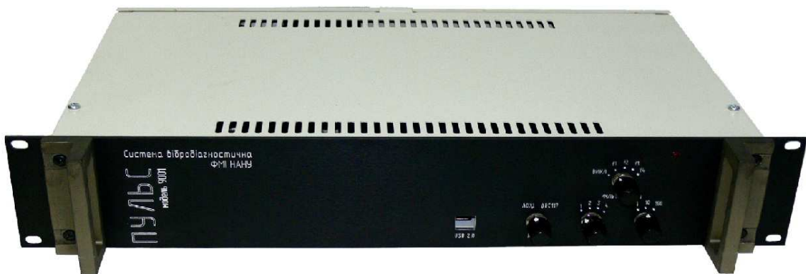
Рис. 8. Зовнішній вигляд багатоканальної вібродіагностичної системи ПУЛЬС
