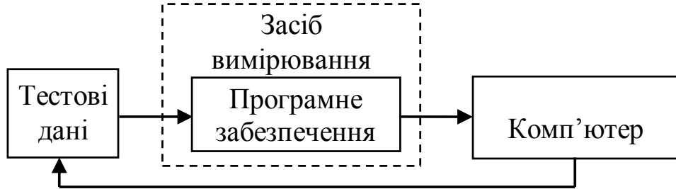
Рисунок 2.3 – Структурна схема метрологічної перевірки ПЗ ЗВ
