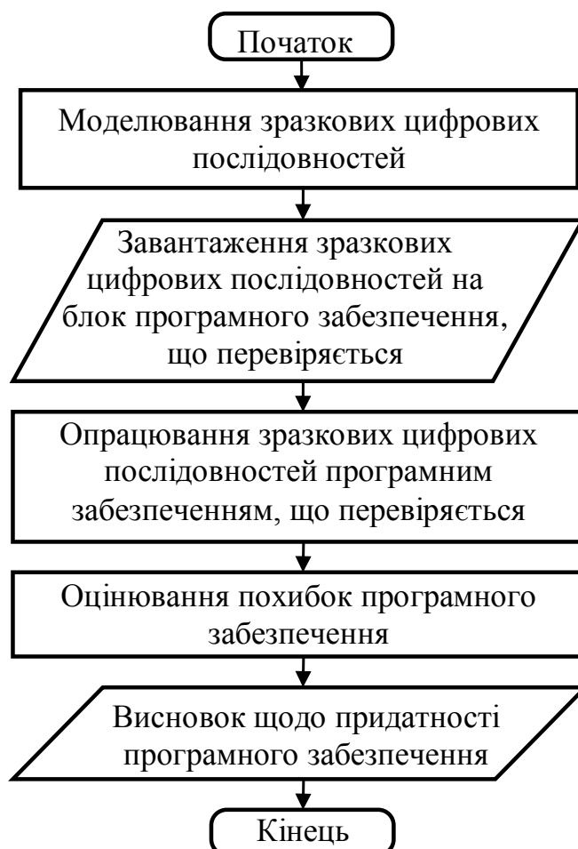
Рисунок 1 - Алгоритм метрологічної перевірки програмного забезпечення засобів вимірювання
