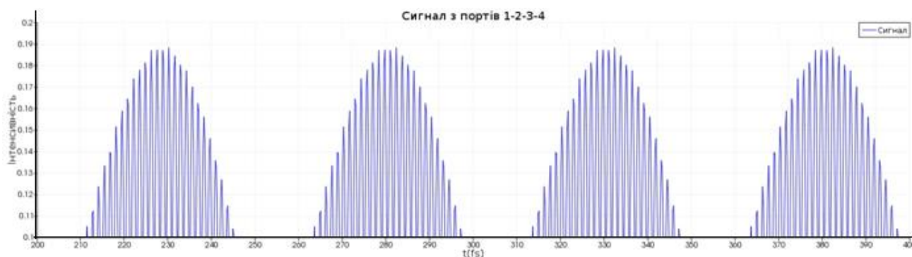
Рис. 2.12 Інтенсивність отриманого сигналу на виході чотирьохканального мультиплексора включеного як суматор по амплітуді 0,1 інтенсивності.
