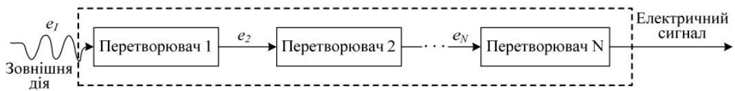
Рис. 1.19. Загальний вигляд багатоконпонентного сенсора, що складається з N -перетворювачів: e_1 , e_2 , e_N – різні види енергії [67]
