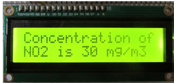
Рис.4.17. Результати вимірювання концентрації шкідливих газів: а) CO_2 ; б) SO_2 ; в) NO_2 виведені на рідкокристалічний дисплей LCD1602
