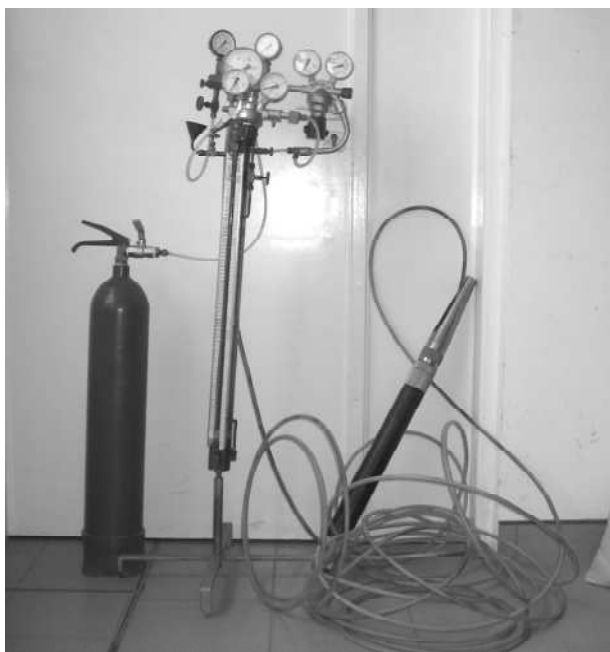
Rys. 2. Presjometr typu PP11 po modernizacji w Zakładzie Geotechniki i Hydrotechniki Politechniki Rzeszowskiej
