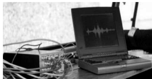
Obr. 1 Absolútne snímače zrýchlenia kmitania a A/D prevodník a PC s programovým vybavením DAS 16
