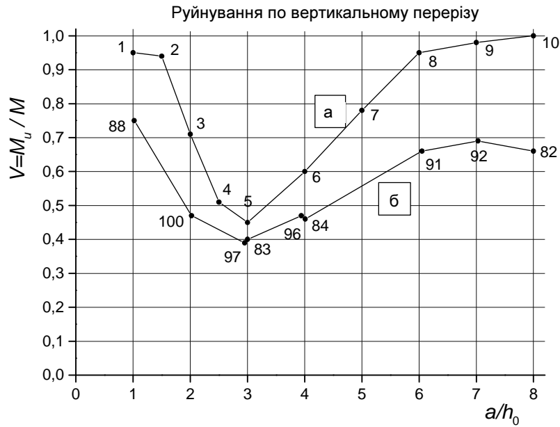
Рис. 3. Залежність V = M_u / M від параметра a/h_0 : а – за дослідями Ф. Леонгардта і Р. Вальтера [7] при p = 2,0\% ; б – за дослідями Г. Кані [9] при p = 2,7\% (цифрами позначено номери балок)
