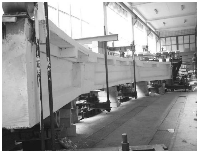
Рис. 5. Загальний вигляд досліджуваної конструкції прогонової будови естакади на кривій на випробувальному стенді
