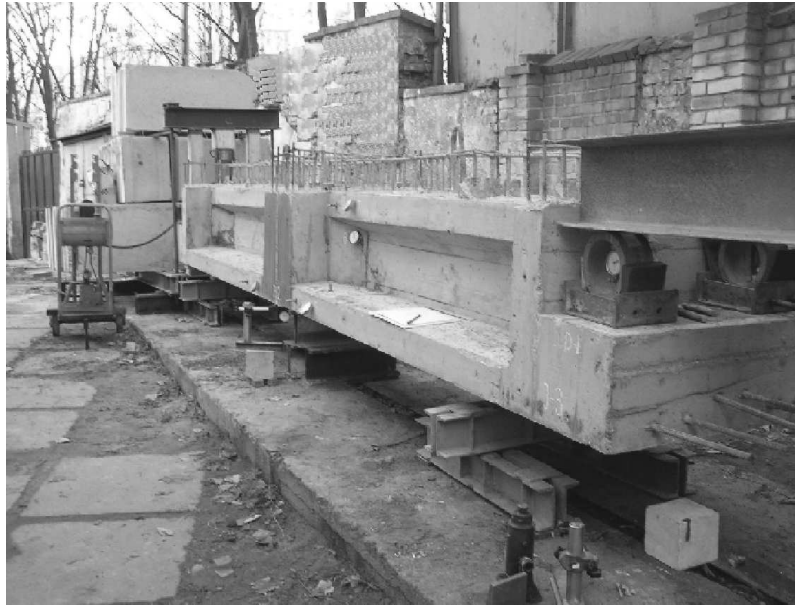
Рис. 4. Загальний вигляд досліджуваної конструкції балки монолітної ділянки, підготовленої до випробувань на стенді
