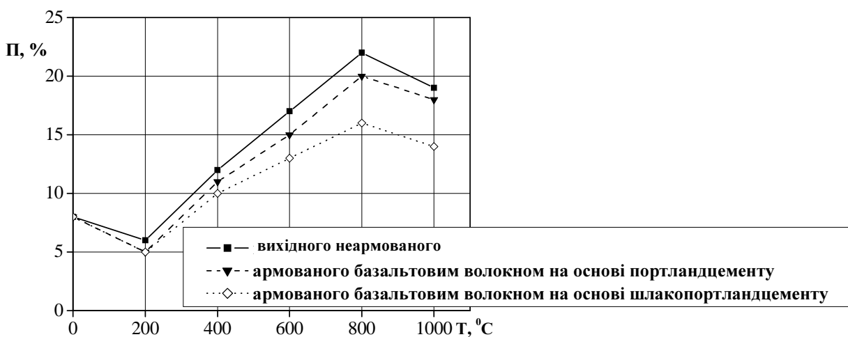
Рис. 2. Зміна пористості бетону при нагріванні
