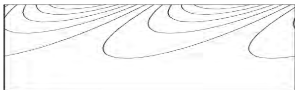
Рис. 7. Розподіли електромагнітних полів при f = 1 Гц: а – Q = 0,15 \cdot 10^6 А/м; б – Q = 0,15 \cdot 10^7 А/м
