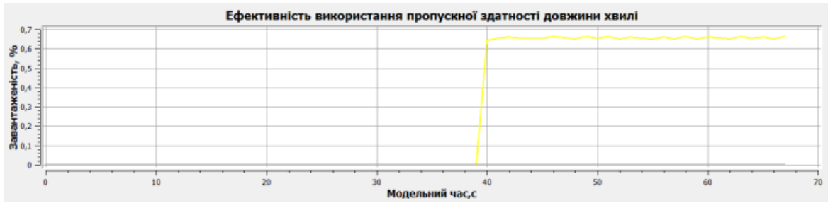
Рис. 4.15. Завантаженість оптичного тракту між двома вузлами (1 та 2) мережі для (а) першого та (б) другого волокон
