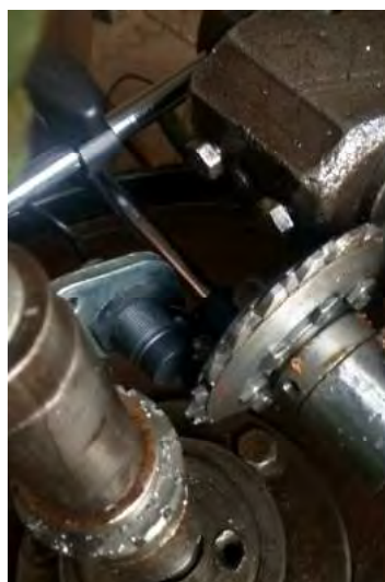
Рис.5.7. Робочий простір верстата з здавачем для вимірювання сили різання на збірній фрезі
