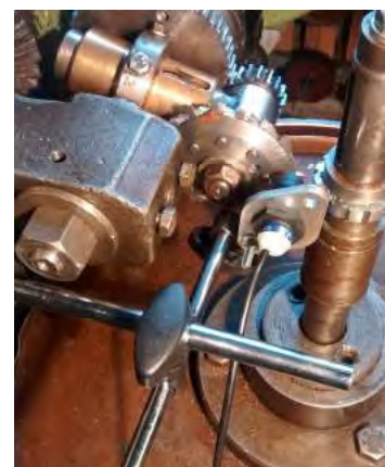
Рис.5.7. Робочий простір верстата з здавачем для вимірювання сили різання на збірній фрезі
