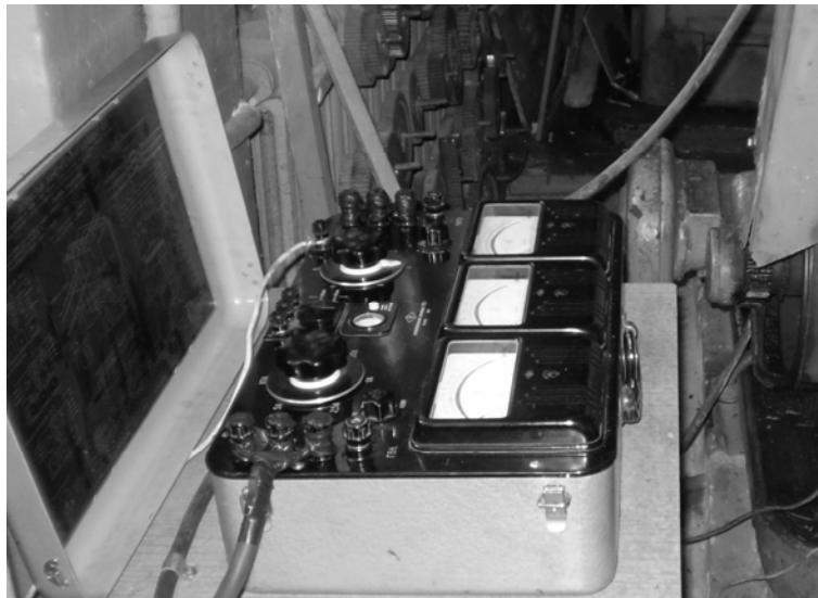
Рис.Б.1. Вимірювальний комплект К50 для вимірювання загальної потужності, яка споживається трьохфазним двигуном приводу зубофрезерного верстату
