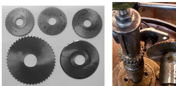
Рис.14. Комплект дискових фрез (а) та робочий простір верстата (б)
