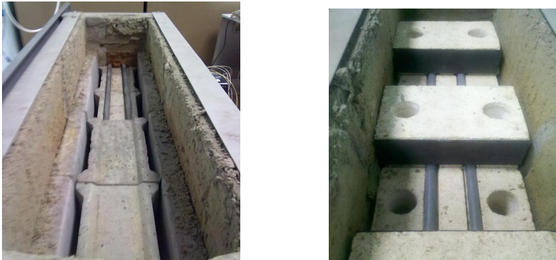
а б Рис. 6. Теплоакуючі елементи ЕТА з магнезиту (а) та шамоту (б)
