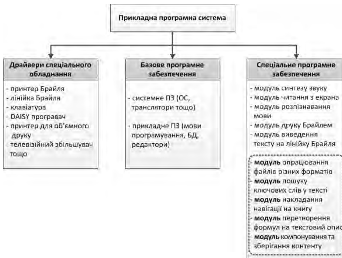
Рис. 1. Структурна схема прикладної системи опрацювання україномовних технічних текстів для людей з вадами зору
