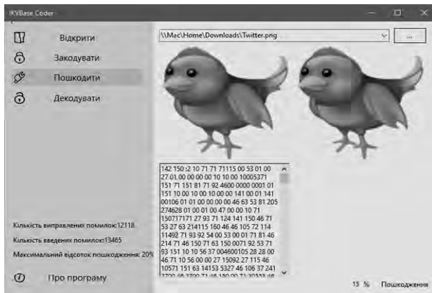
Рис. 8. Загальний вигляд програми, яка моделює роботу заводстійкого коду на основі ІКВ
