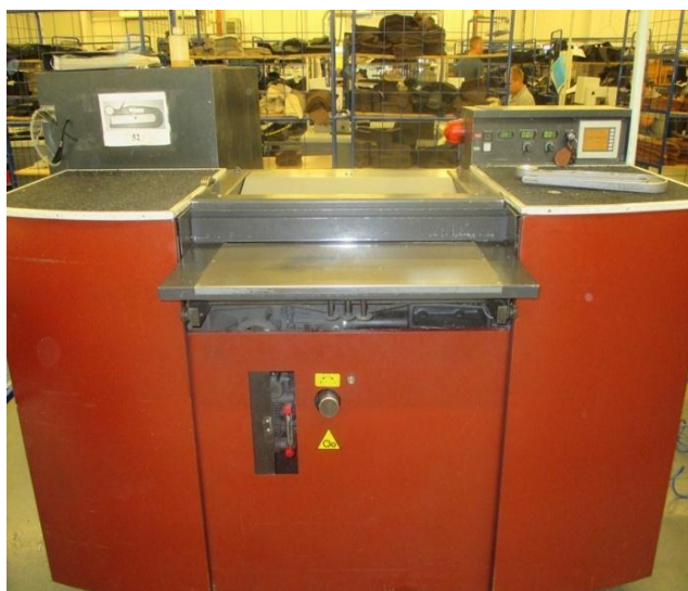
Рисунок 4.10 – Машина для стинання ворсистої поверхні шкіри Samoga 620
