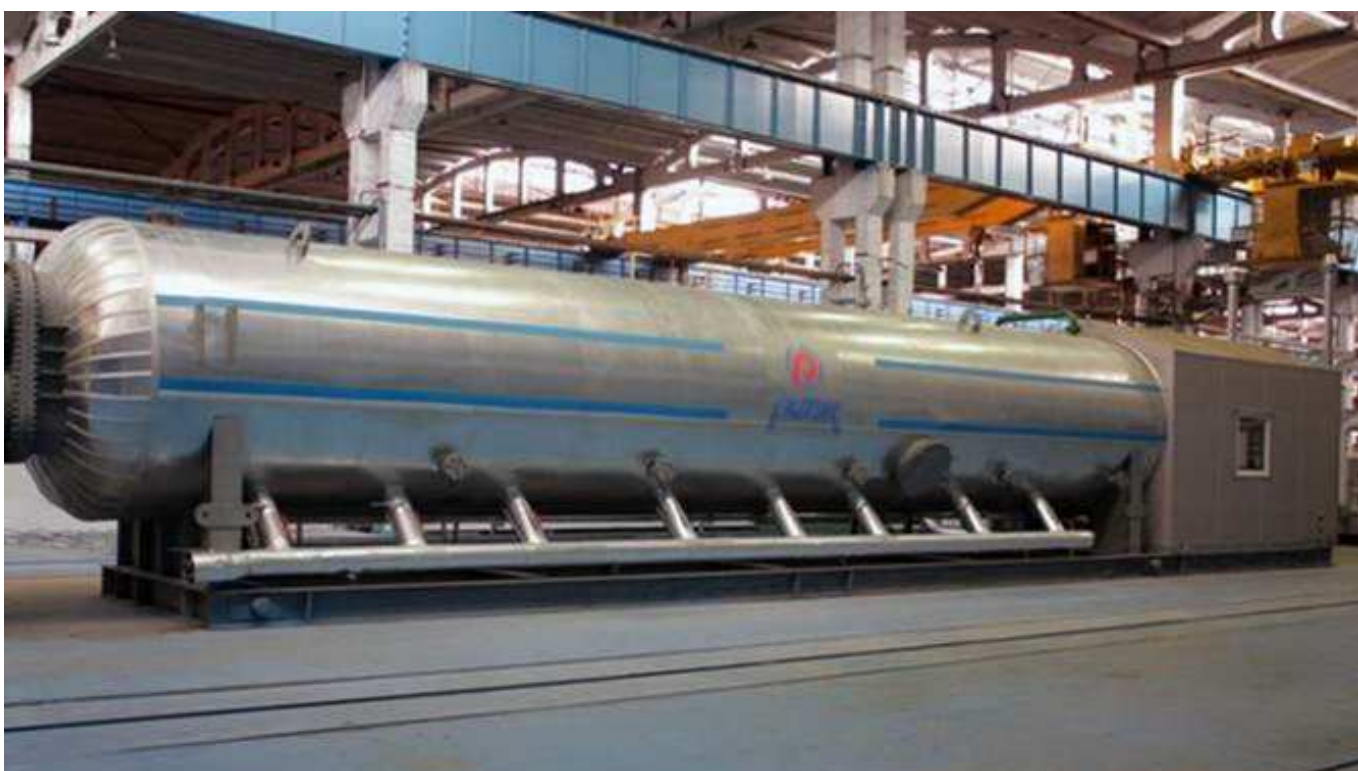
Рисунок 6.12 – НГВРП типу «HEATER-TREATER» на складальному майданчику машинобудівного виробництва (Група «ЛУКОЙЛ», РИТЭК, 2015 р.)
