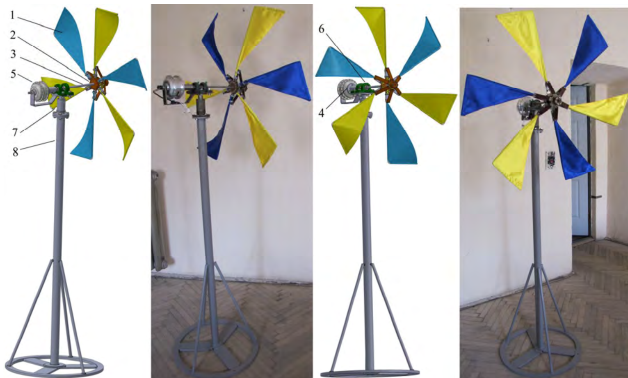
Рис. 2. Загальний вигляд твердотільної моделі та дослідного зразка горизонтально-осьової вітроустановки з лопатями вітринного типу
