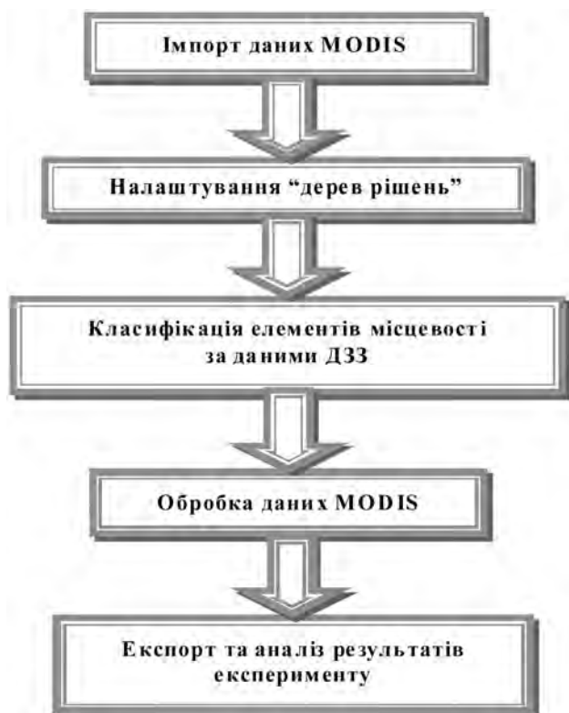
Рис. 2. Технологічна схема визначення площ спалених територій за даними MODIS
