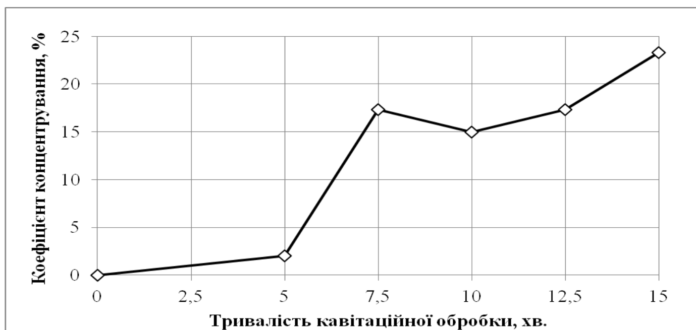
Рисунок 5.2 – Залежність ступеня концентрування від тривалості обробки біомаси в кавітаційному полі після 24 год відстоювання в полі гравітаційних сил.
