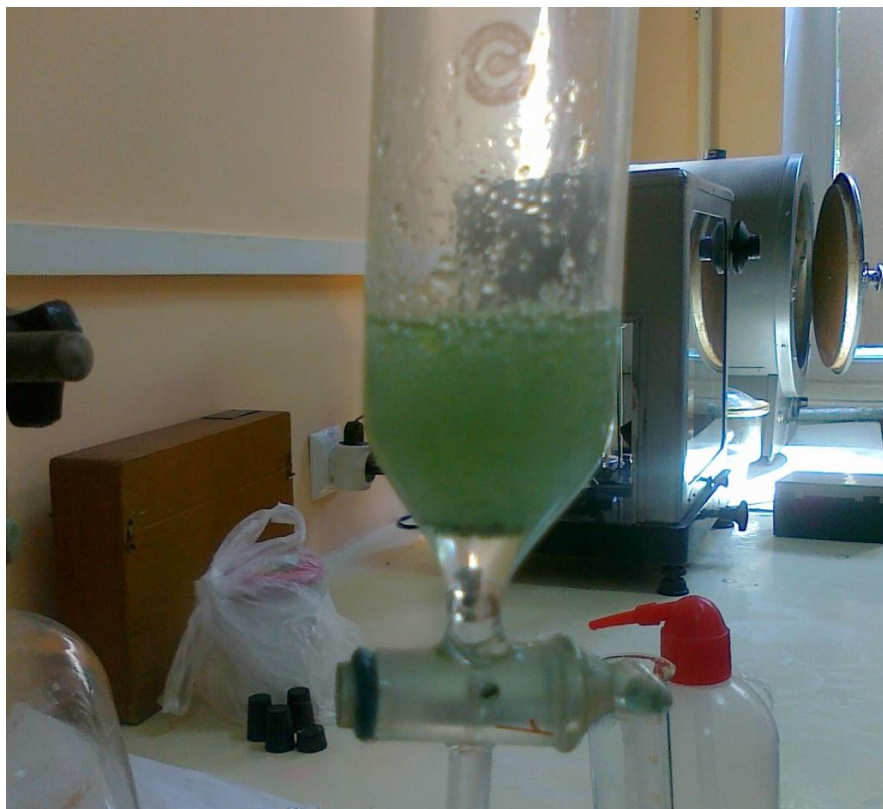
Рисунок 2.7 – Світлина екстрагування ліпідів із синьо-зелених водоростей.
