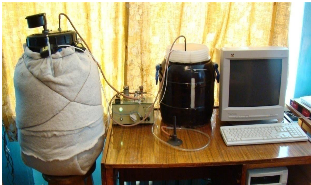
Рисунок 3.7 – Лабораторна установка, в якій відбувалося анаеробне бродіння маси ціанобактерій (ліворуч – реактор, праворуч – система обліку виходу біогазу).
