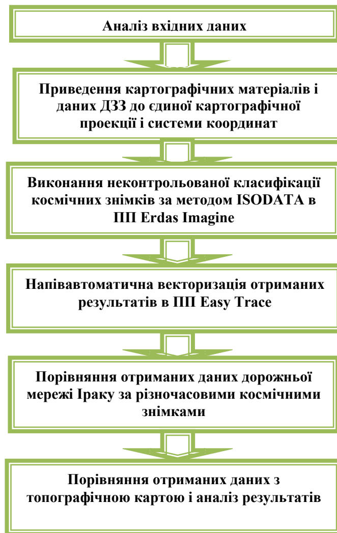
Рис. 12. Технологічна схема автоматичного виділення дорожньої мережі Іраку за растровими даними в ПП Erdas Imagine
