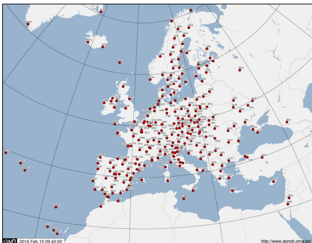
Рис. 1.10 Схема мережі постійних станцій EPN на території Європи
