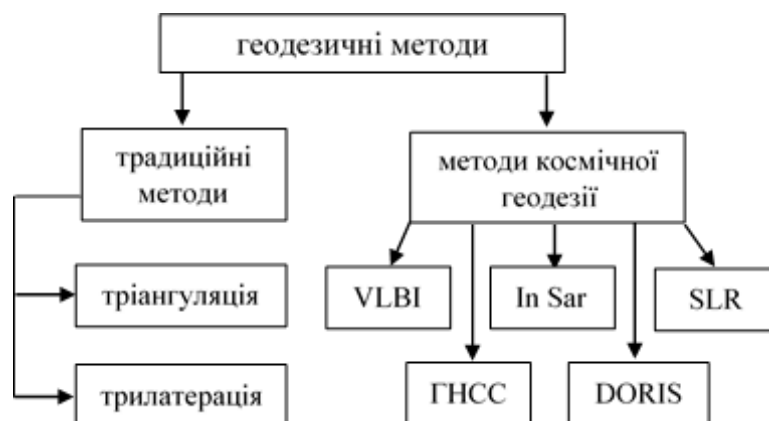
Рис. 1.8 Геодезичні методи вивчення горизонтальних рухів земної кори
