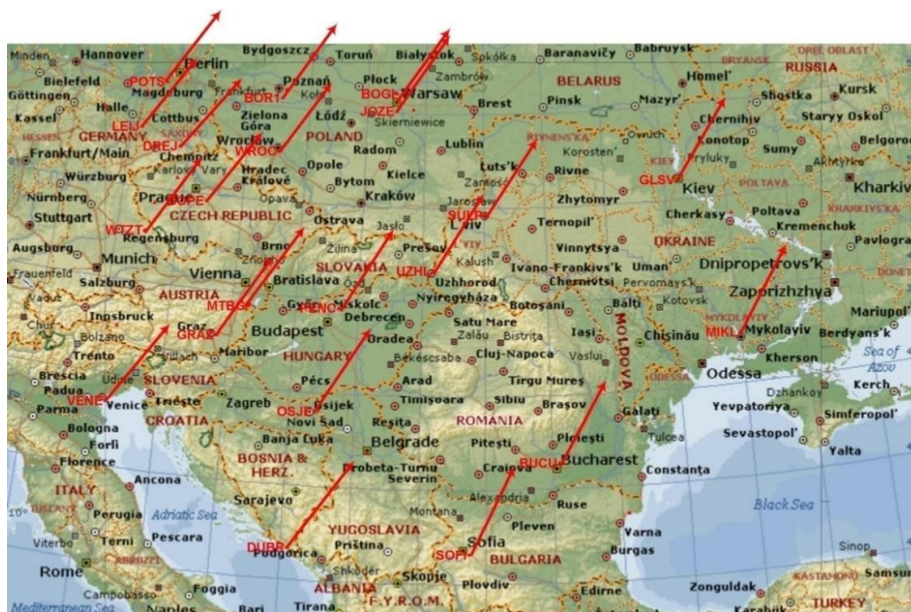
Рис. 2.17 Карт-схема розподілу горизонтальних зміщень перманентних ГНСС-станцій, розташованих в регіоні Карпато-Балканської дуги
