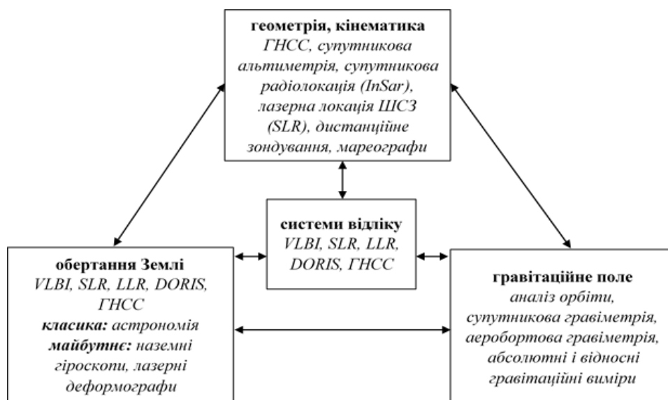
Рис. 1.7 Оптиміальне поєднання методів космічної геодезії у визначення геодинамічних параметрів Землі
