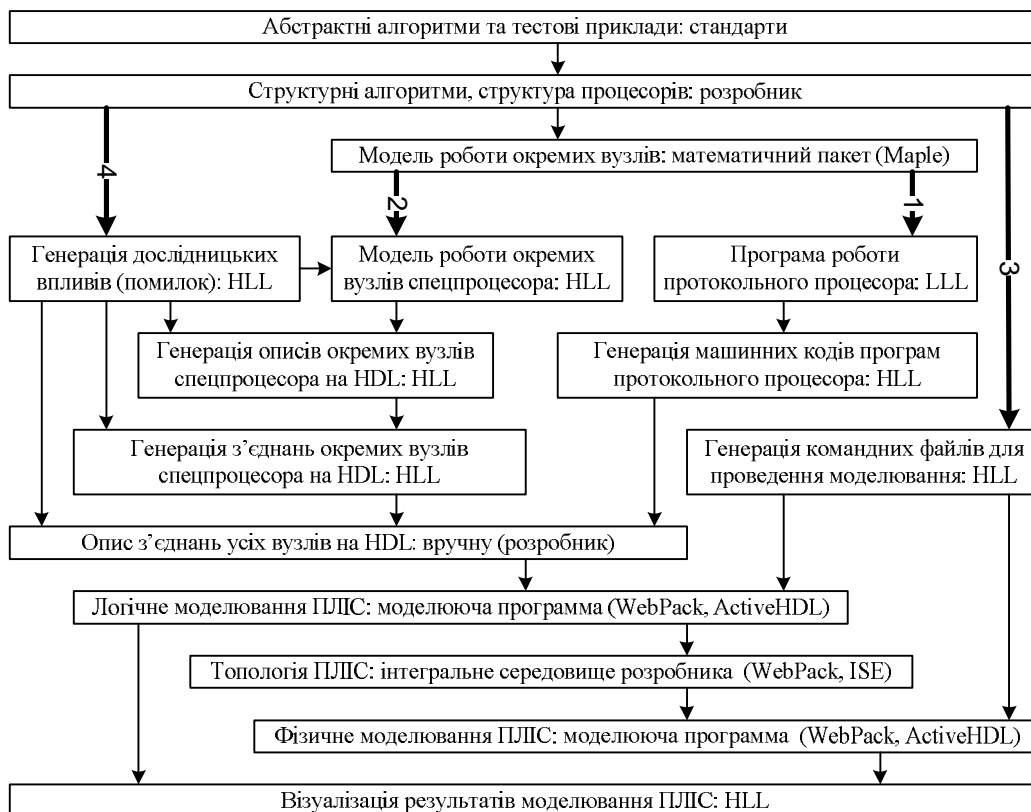
Рис. 8. Послідовність проектування описів функціональних вузлів
