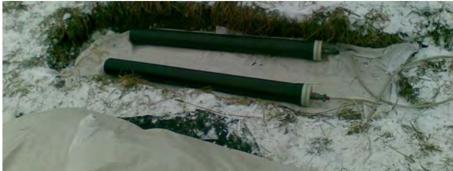
Рис. 6. Розташування індукційних давачів під час вимірювання шумів
