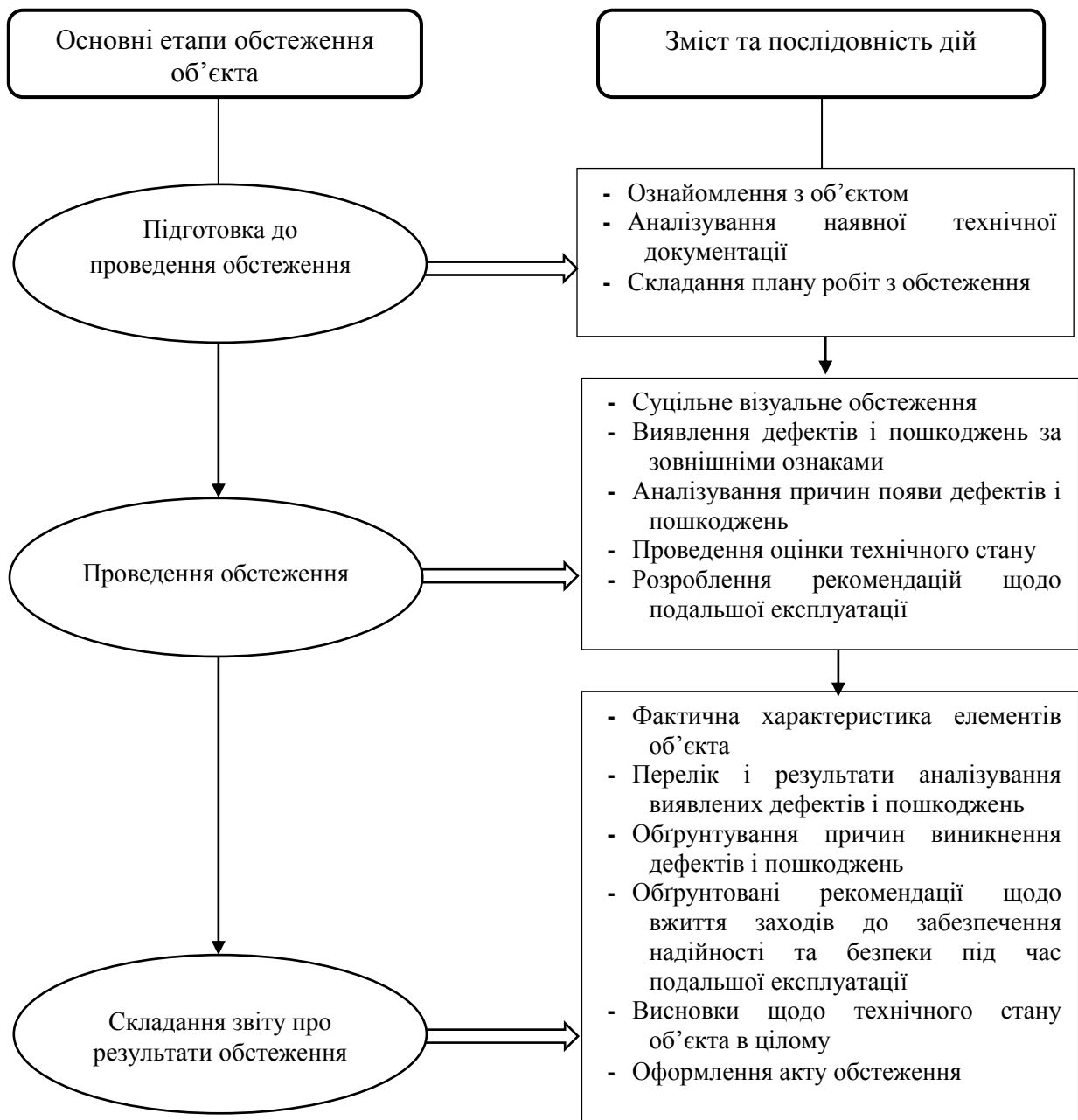
Рис. 3.8. Проведення обстеження та оцінки технічного стану об'єкта*
