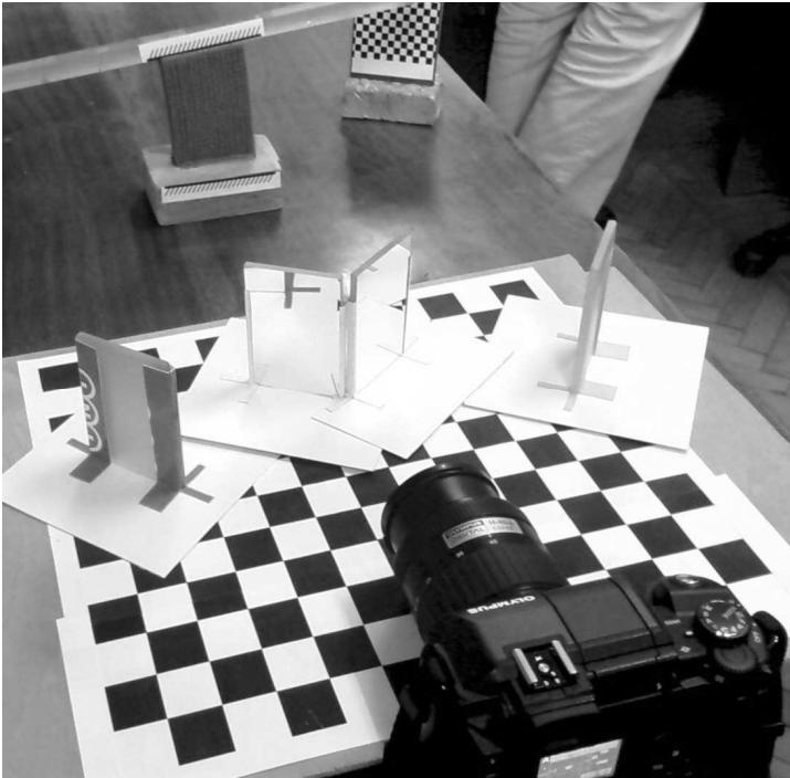
Рис. 8.14. Експериментальна система формування стереопари для реєстрації переміщень у тривимірному просторі: 1 - об'єкт, переміщення поверхні якого досліджується; 2 - система дзеркал, що формують стереопару; 3 - оптична система камери; 4 - екран камери, на якому реєструється стереозображення
