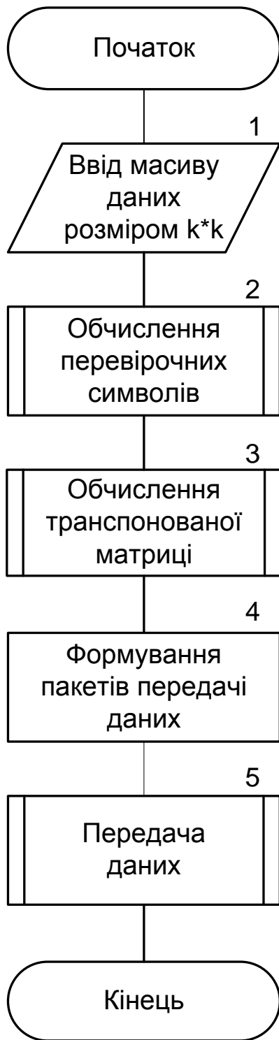
Рисунок 3.7 – Алгоритми передачі і приймання даних на основі декомпозиції: а) алгоритм передачі даних; б) алгоритм приймання даних
