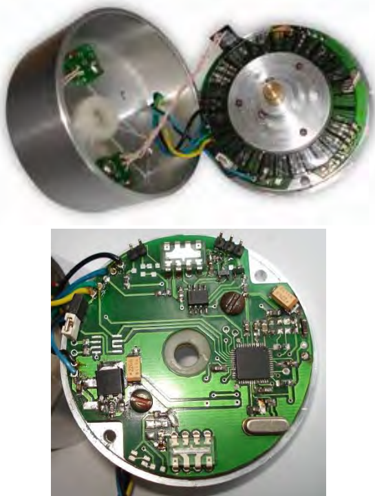
Рис. 5. Дослідний зразок оптикоелектронного сенсора кута
