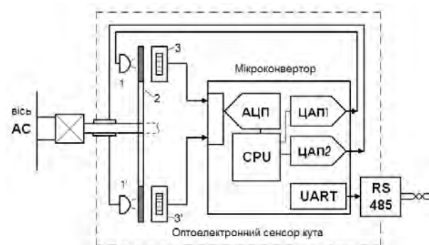
Рис. 1. Структурна схема сенсора кута з компенсацією зміщення осі
