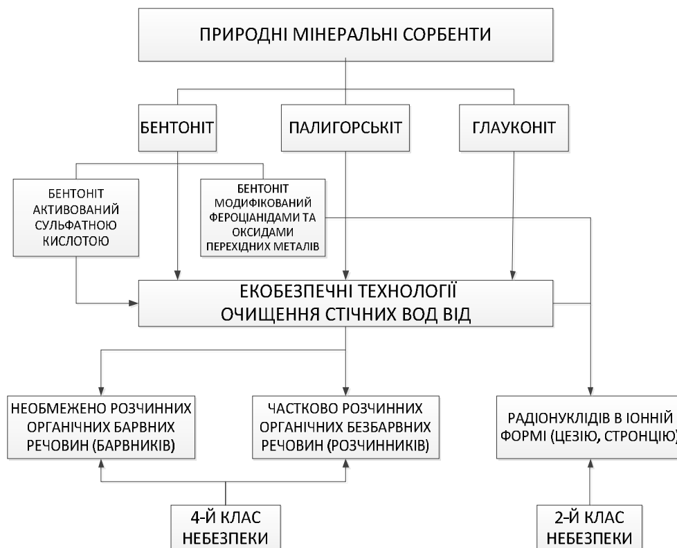
Рис. 2. Класифікація використання природних та модифікованих сорбентів у технологіях очищення стічних вод від забрудників другого–четвертого класу небезпеки
