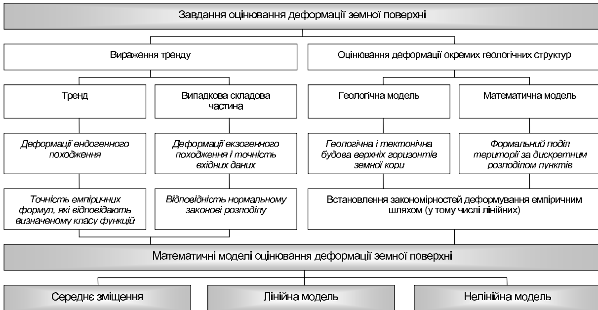
Рис. 1. Зміст завдань і математичні моделі оцінювання деформації земної поверхні Fig. 1. The content of tasks and mathematical models of estimating the earth's surface deformation
