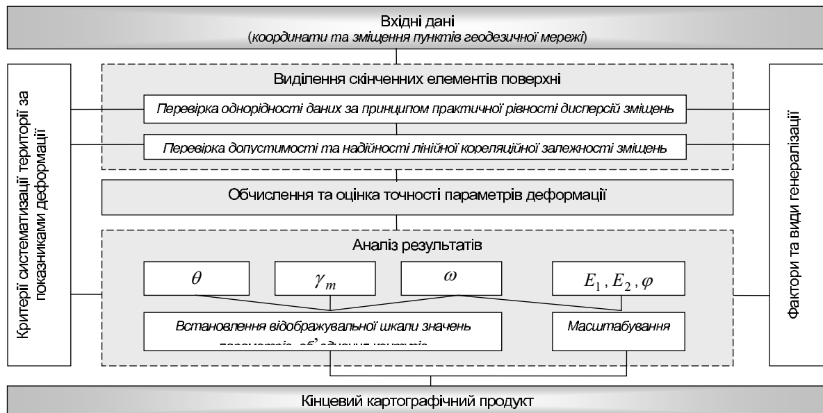
Рис. 2. Методика математико-картографічного моделювання лінійних деформацій земної поверхні [Тадєєва та ін., 2014]
