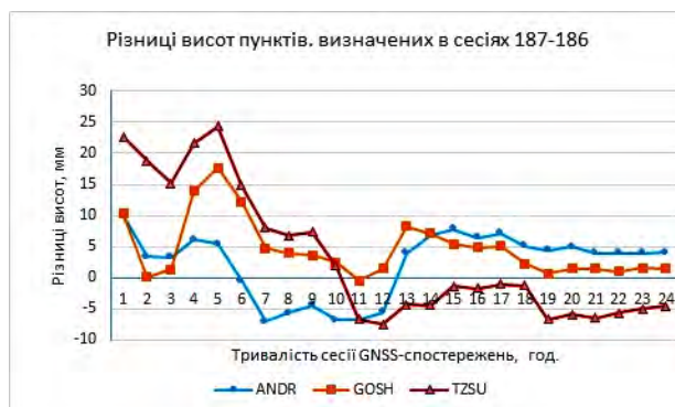
Рис 3. Графіки різниць висот пунктів ANDR, GOSH і TZSU між сесіями 186 і 187 Fig. 3. Graphs differences of the heights point ANDR, GOSH and TZSU between sessions 186 and 187
