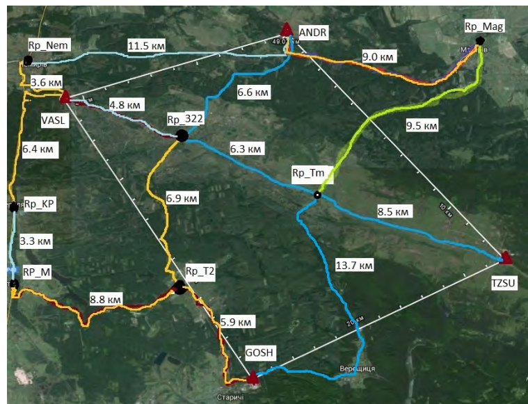
Рис. 4. Нівелювання пунктів фундаментальної геодезичної мережі Fig. 4. Geometric spirit leveling of the points of fundamental geodetic network
