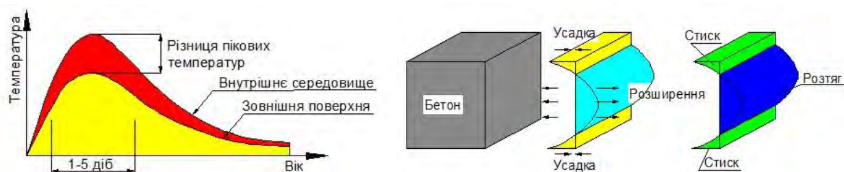
Рис. 2. Схема процесу тріщиноутворення під час гідратації бетону
