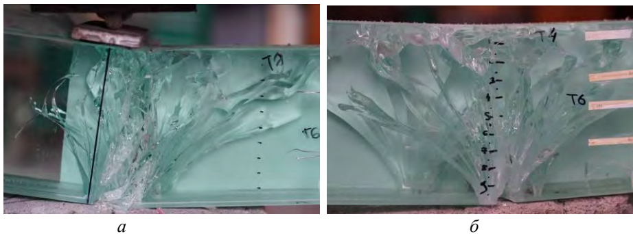
Рис. 6. Руйнування експериментальної балки в зоні чистого згину біля точки прикладання завантаження: а – балка марки БС-1; б – балка марки БС-2
