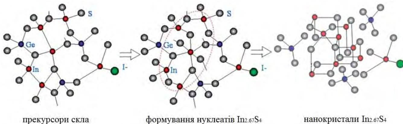
Рис. 1.14. Схематична ілюстрація процесу кристалізації In_{2,67}S_4 в скляній матриці GeS_2-In_2S_3-CsI .
