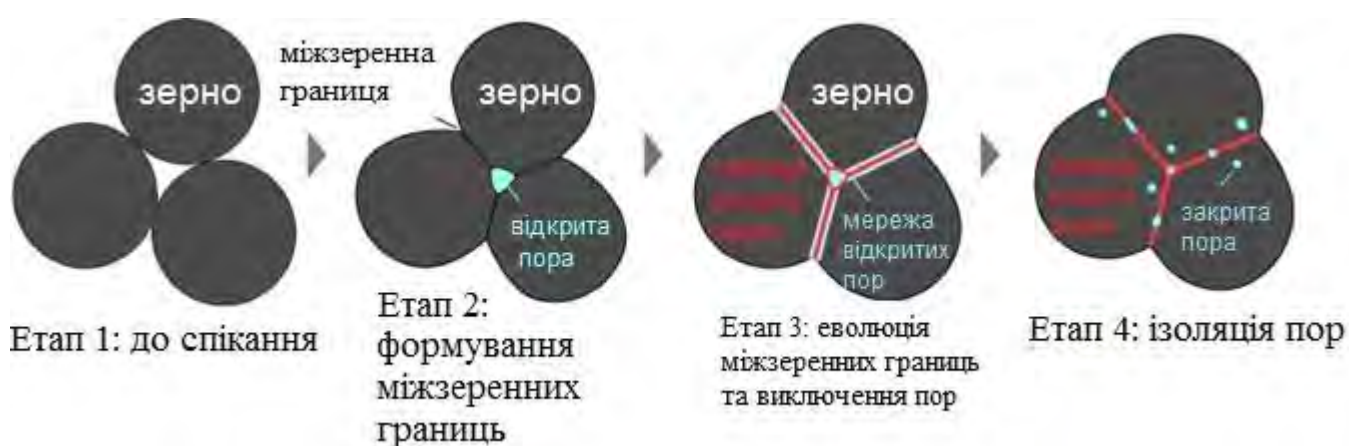
Рис. 1.17. Етапи спікання поруватої кераміки.
