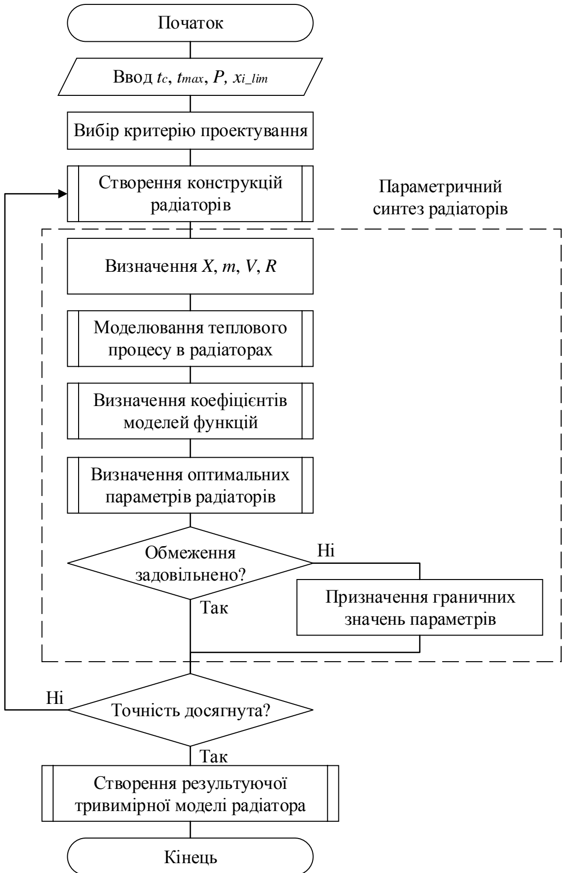
Рисунок 4.4 – Схема алгоритму автоматизованого проектування радіаторів
