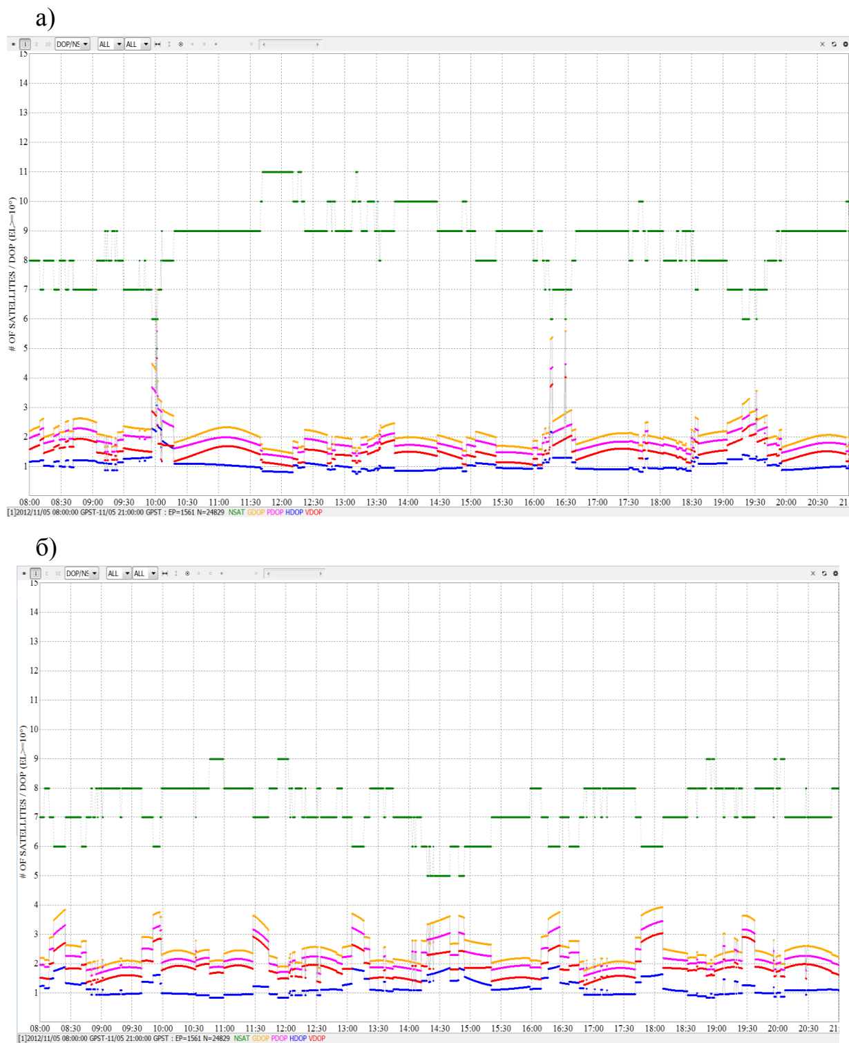
Рис. 3.8. Графіки зміни супутників систем GPS (а) та ГЛОНАСС (б) при куті відсічки 10^\circ для пункту СТ54
