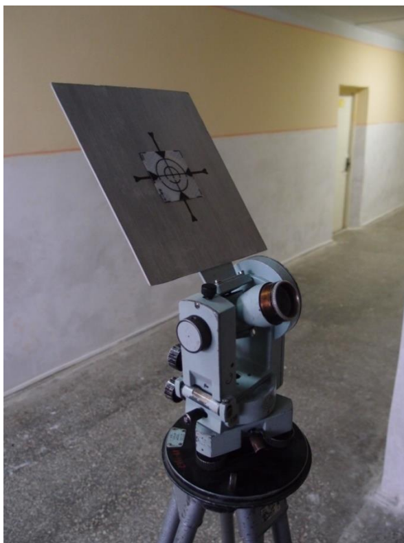
Рис. 3.9 Зовнішній вигляд теодоліта із закріпленим плівковим відбивачем
