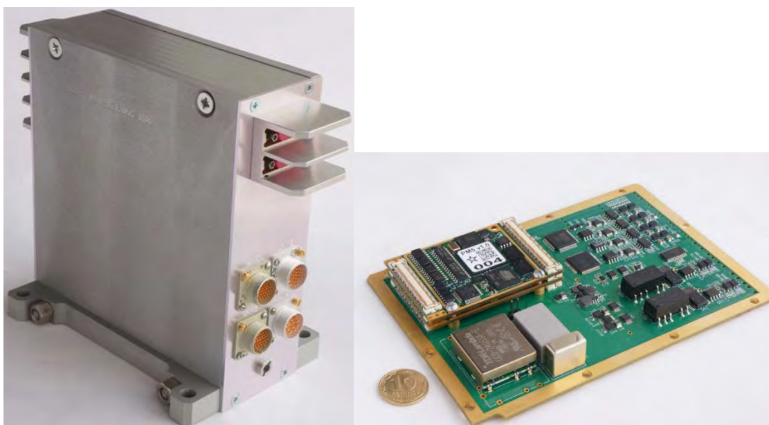
Рис. 4 Зовнішній вигляд центрального блоку та резервованого ПМ.
