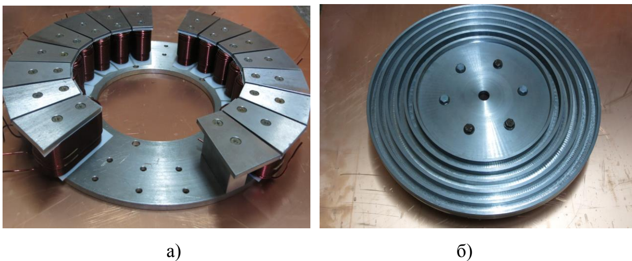
Рис. 4.49. Конструкція ЕПМЕТ: а) індуктор: б) ротор (вигляд знизу)
